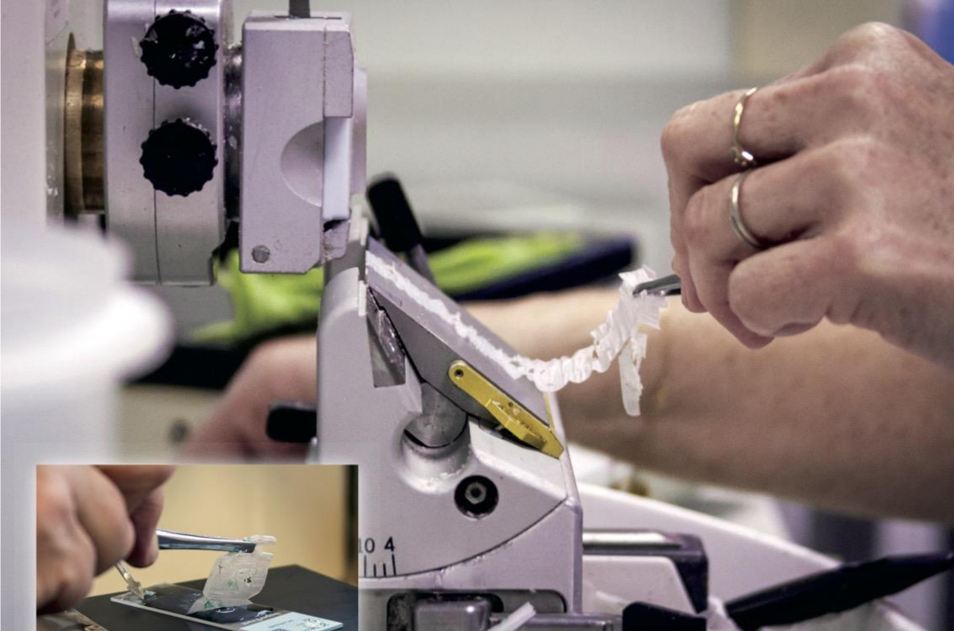
Coupe du bloc au microtome, pour réaliser un ruban d'une épaisseur de 3 à 5 microns. Apposition sur lame du ruban coupé au microtome.
